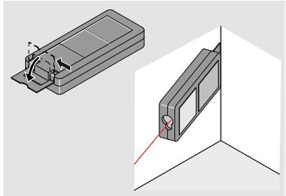
**i** Die Ausrichtung des Endstücks wird automatisch erkannt und der Nullpunkt entsprechend angepasst.
