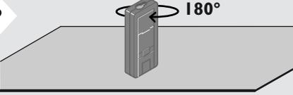
Gerät horizontal um 180° drehen und erneut auf absolut ebene Oberfläche stellen.
