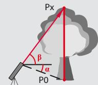
Lasere auf die oberen Punkte richten. Das Winkel- / Höhentacking startet automatisch.
