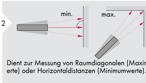
Die gemessene Minimum- und Maximumdistanz wird angezeigt (min, max). Der zuletzt gemessene Wert wird in der Hauptzeile angezeigt.
