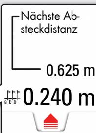
Bei einer Entfernung von weniger als 0.1 m zum nächsten Absteckpunkt beginnt das Gerät zu piepen. Diese Funktion kann durch Drücken der Taste CLEAR/OFF beendet werden.
