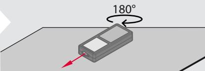
Gerät horizontal um 180° drehen und erneut auf absolut ebene Oberfläche stellen.
